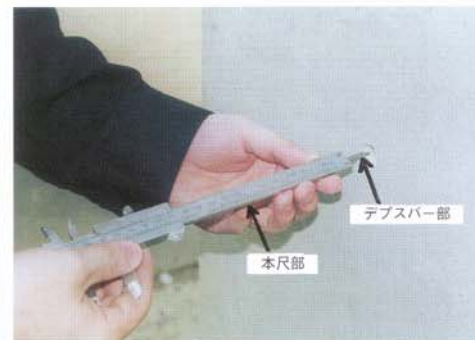
写真-3 削孔深さの測定状況
