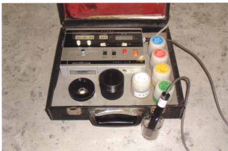
写真-2 塩化物イオン濃度の測定
