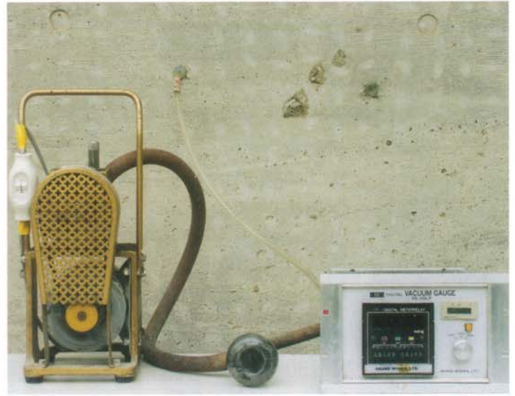
写真-2 簡易透気試験の接続
