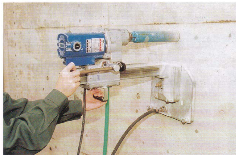
写真-1 コンクリートコアマシンによる \phi 50mm コア採取状況
